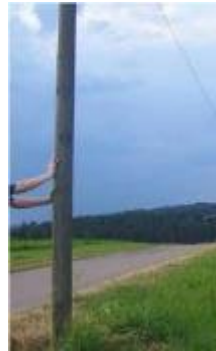
Abbildung 62: Druckprüfung am Mast
