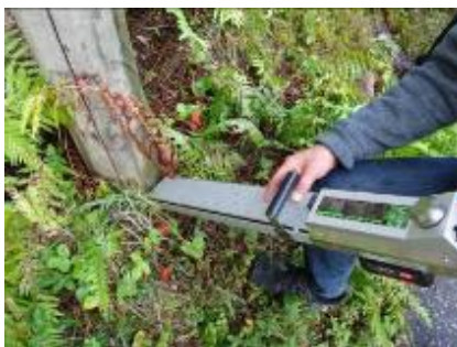
Abbildung 63: RESI PD-400 in Prüfstellung an einem Mast und das Eingabegerät/Handheld (mobiles Android-Endgerät) zur Aufnahme der Inspektionsdaten
