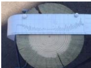
Abbildung 2: Bohrprofil-Beispiel für einen Mast ohne Fäule / Hohlraum → für Wiedereinsatz geeignet
